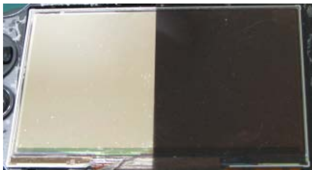
円偏光板なし 円偏光板あり (直線偏光子 + \lambda/4 波長板)
