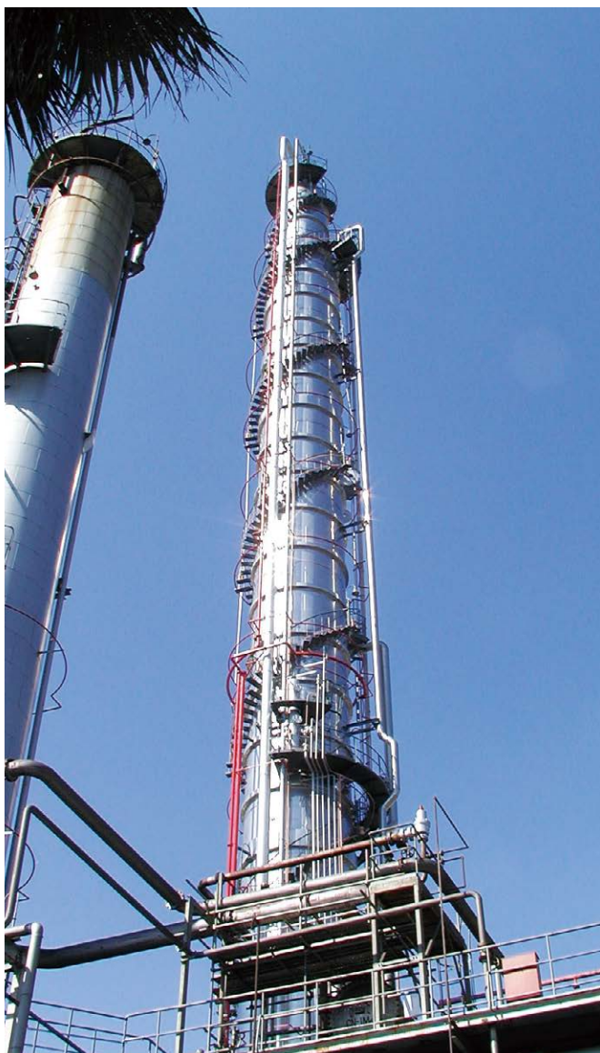
大空にそびえる73メートルのブタジエン抽出塔 C 4 留分からブタジエンを抽出するGPBプラント
