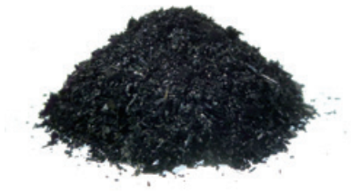
ゼオンのスーパーグロース法による単層カーボンナノチューブ (製品名: ZEONANO®)
