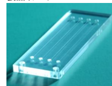
COP プレートの切削加工例
