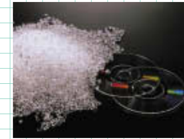
シクロオレフィンポリマーと光ディスク基板
