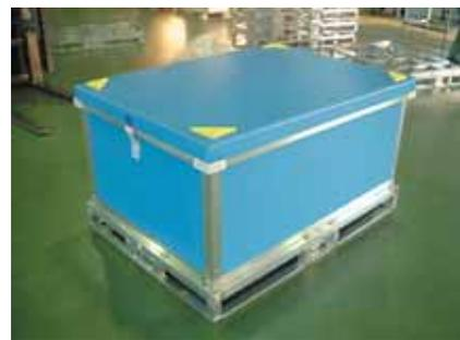
液晶基盤搬送用コンテナ
