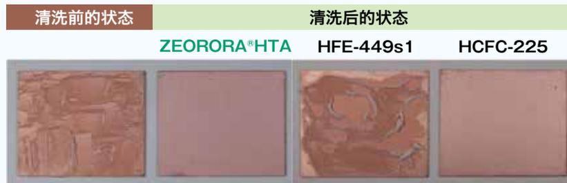
硅润滑脂G40系列 (信越化学工业制 高温润滑用) 超声波清洗 50°C × 1分
