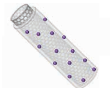
CNT上に触媒粒子が乗っているイメージ図
