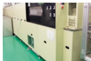
単層CNT大面積対応型連続CVD(化学気相成長)合成炉(全長12m)
