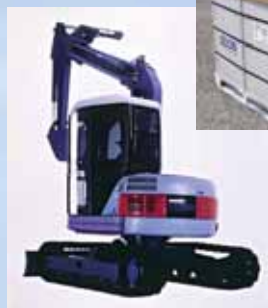
RIMにより製作した建設機械の外装
