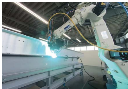
新溶接技術(レーザーアークハイブリット溶接)
